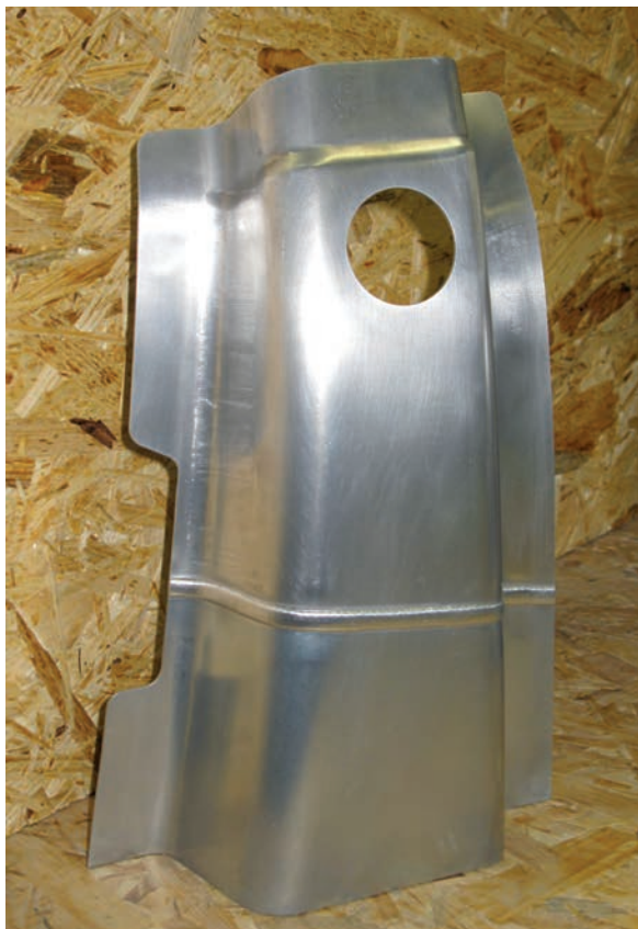
Υβριδικές λαμαρίνες πάχους 1,2 - 1,5 mm και διαστάσεων 200 X 300 mm συγκολλούνται με ταχύτητα 78 cm/mín, πριν πάνε για διαμόρφωση και γίνουν τμήματα οροφής οχημάτων
