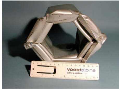
Όταν ο σχεδιασμός της υβριδικής αυτή λαμαρίνας σχεδιάζεται με βάση την ασφάλεια, τότε μπορεί να λειτουργήσει και ως "ασπίδα" σε περίπτωση ατυχήματος και να απορροφήσει μέρος της ενέργειας.
