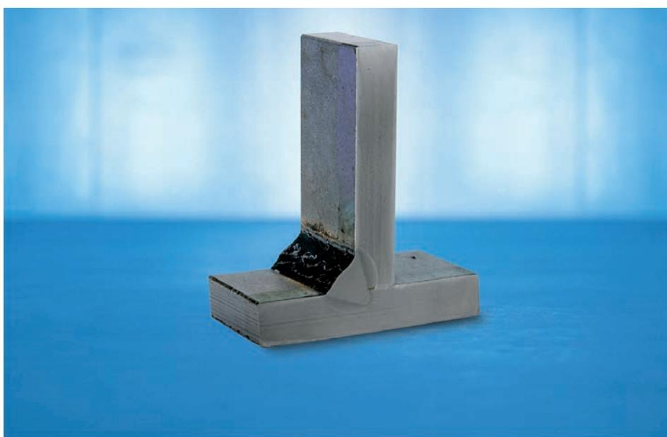
**Η σειρά TransSteel Yard χαρακτηρίζεται από συγκόλληση με βαθιά και ομοιόμορφη διείσδυση. Αυτό εξασφαλίζει την απαραίτητη αντοχή στις ραφές συγκόλλησης των πλοίων και των παράκτιων κατασκευών.**
