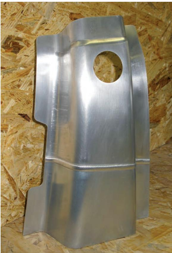
Υβριδικές λαμαρίνες πάχους 1,2 - 1,5 mm και διαστάσεων 200 X 300 mm συγκολλούνται με ταχύτητες 78 cm/min, πριν πάνε για διαμόρφωση και γίνουν τμήματα οχημάτων
